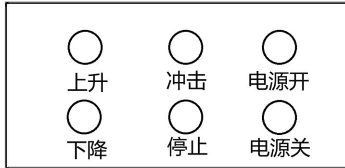
电气控制柜面板图
